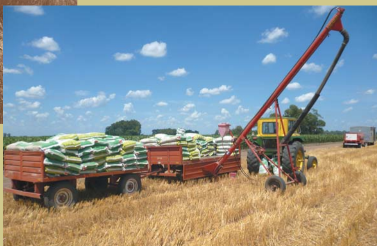
5. Приспособление для загрузки семян сои в сеялку и их инокуляции
